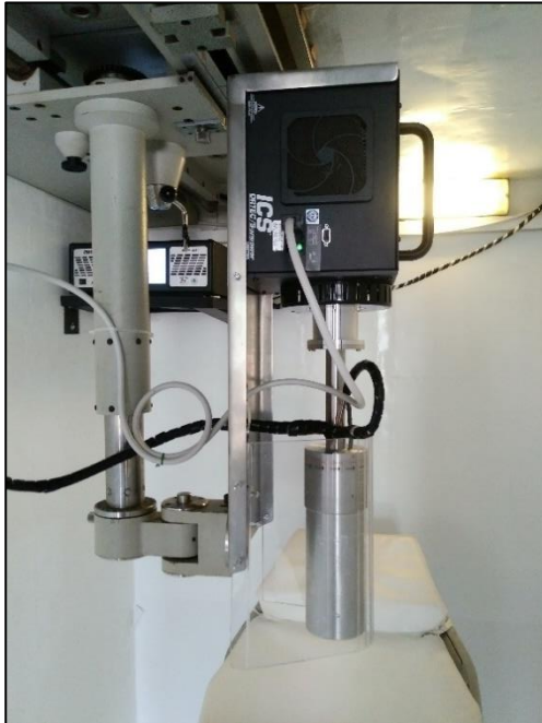
Figura 1 a) Rivelatore HPGe e b) geometria di taratura del sistema WBC di Caorso
