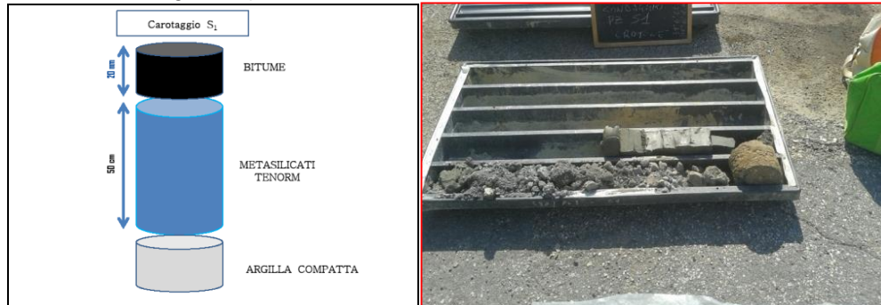
Figura 4: profilo verticale di una carota della città di Crotona
