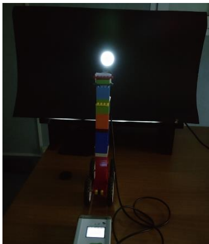
Figura 2 – Monitor con schermatura e supporto per il rivelatore del luxmetro.
