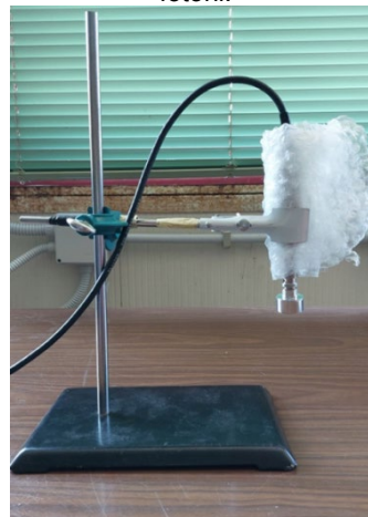
Figura 2 – Il rivelatore CZT impiegato nelle misure con i fotoni.
