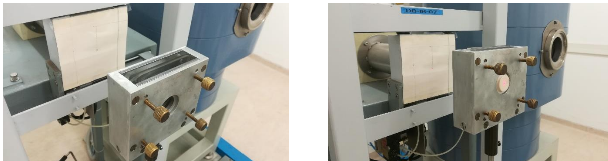
Fig 7 Setup per misure dello spessore emivalente (HVL)
