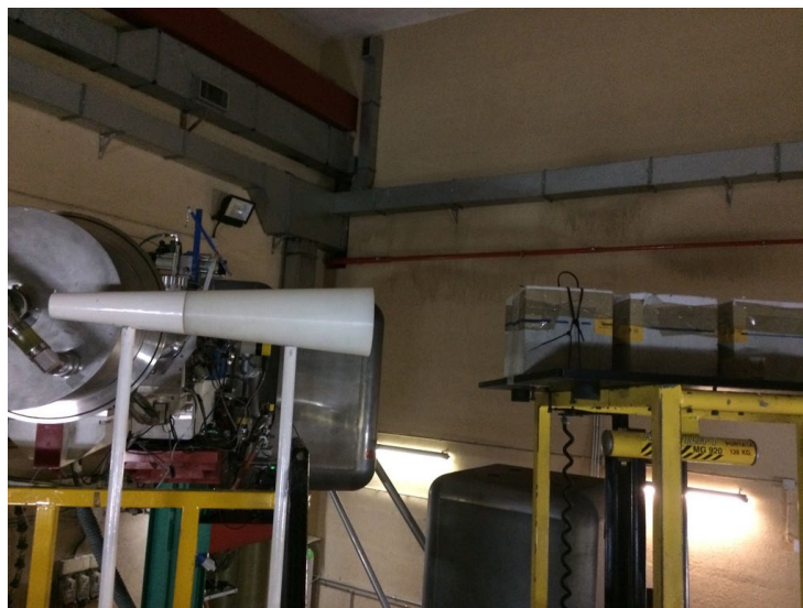
Figura 3 – Setup sperimentale per le misure con i neutroni ad FNG (con cono d'ombra inserito).
