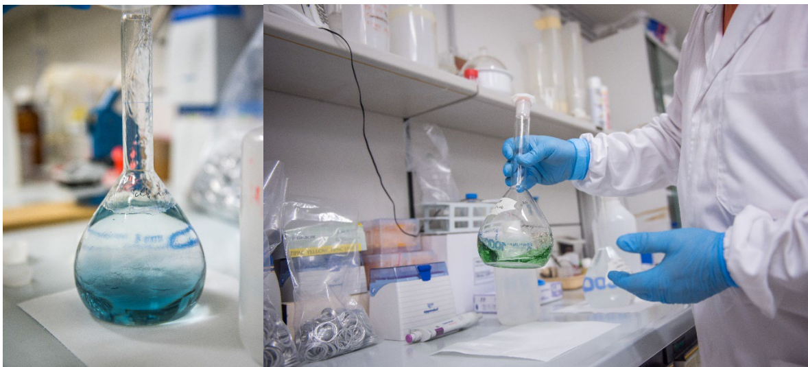
Aggiunta dei carrier alla soluzione acida
