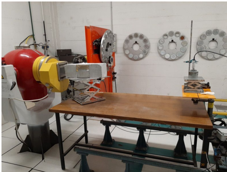
Figura 4 – Misure di attenuazione (45 cm totali di cemento) con la sorgente di ^{60}\text{Co} del laboratorio ENEA di Bologna. Il rivelatore (a destra) è inserito in uno schermo cilindrico di piombo.
